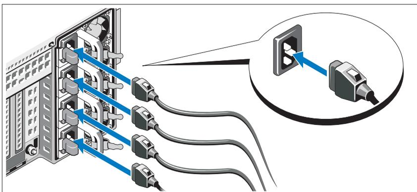
Připojte napájecí kabely k systému, a pokud používáte monitor, připojte napájecí kabel také k monitoru.
