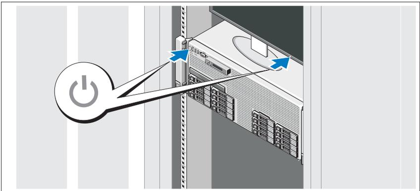
Presione el botón de encendido del sistema y del monitor. Los indicadores de alimentación deberían encenderse.
