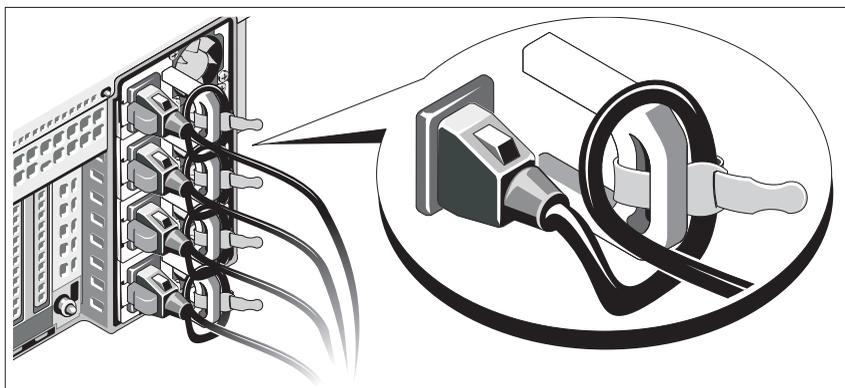
Κάμψτε το καλώδιο τροφοδοσίας του συστήματος σε μορφή βρόχου, όπως φαίνεται στο σχήμα, και χρησιμοποιήστε το συνοδευτικό λουρί για να στερεώσετε το καλώδιο στο βραχίονα.
