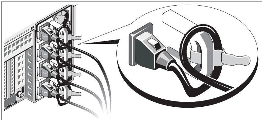
Изогните электрический шнур системы в форме петли, как показано на рисунке, и прикрепите его шиной к скобе.
