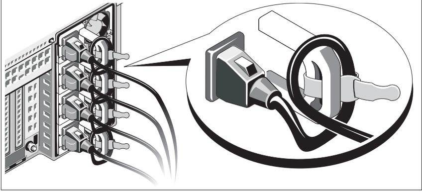
Sistem güç kablosunu resimde gösterildiği şekilde kıvrırın ve sağlanan şeridi kullanarak desteğe sabitleyin.
