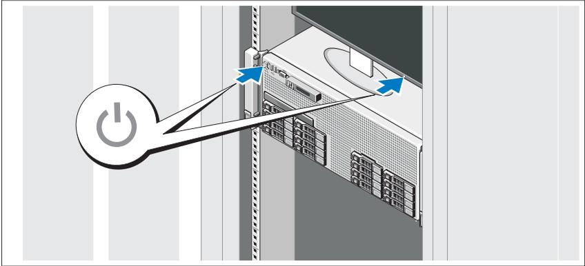
Sistem ve monitör üzerindeki güç düğmesine basın. Güç göstergeleri yanacaktır.
