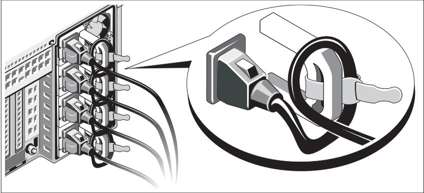
Doble el cable de alimentación del sistema en forma de bucle, como se muestra en la ilustración, y fíjelo al soporte con la correa proporcionada.
