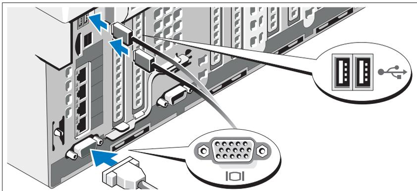
Подключите клавиатуру, мышь и монитор (дополнительно).
